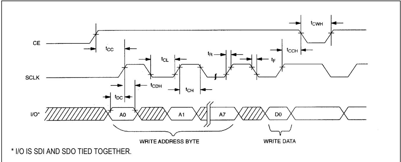
**SPI AC ELECTRICAL CHARACTERISTICS**
