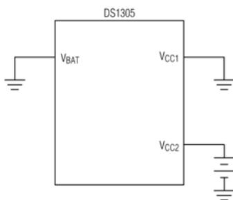
**CONFIGURATION 3: BATTERY OPERATE MODE**
