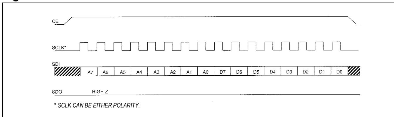
**Figure 7. SPI SINGLE-BYTE READ**
