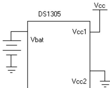
**CONFIGURATION 1: BACKUP SUPPLY IS NONRECHARGEABLE LITHIUM BATTERY**
