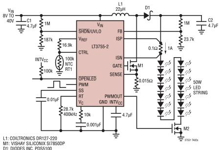
M1: VISHAY SILICONIX SI7850DP D1: DIODES INC. PDS5100 M2: VISHAY SILICONIX SI2308DS RT1: MURATA NCP18WM1045
