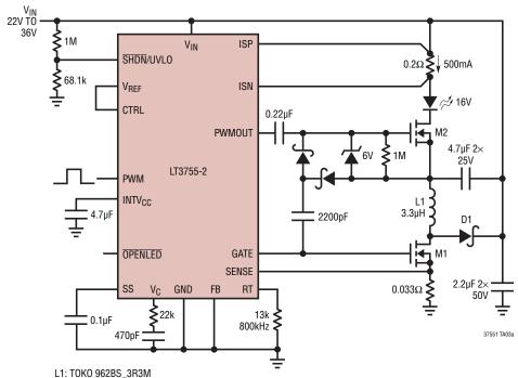
L1: TOKO 962BS\_3R3M M1: VISHAY SILICONIX SI7850DP M2: VISHAY SILICONIX SI2306DS D1: DIODES, INC SBM540
