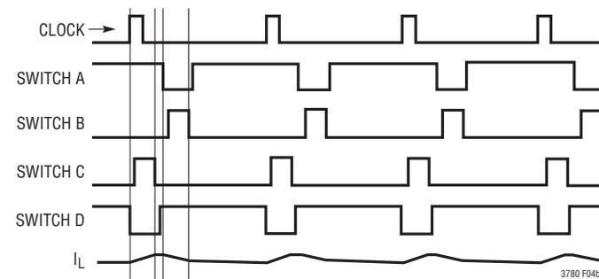
(4b) Buck-Boost Mode ( $V_{IN} \leq V_{OUT}$ )
