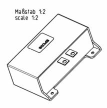
Kriechstrecke: 9 mm Luftstrecke: 9 mm Creep distance: 9 mm Distance in air: 9 mm
